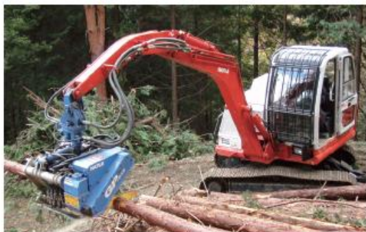
プロセッサ＝林地または土場で、伐採木の枝払い、玉切りと、それらの丸太の集積作業を一貫して行う林業機械の一つ
