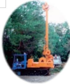
タワーヤーダを活用した架線系集材のイメージ図。（列状間伐）例：斜面下方の伐倒木を斜面上方のタワーヤーダで引っ張り上げる。
