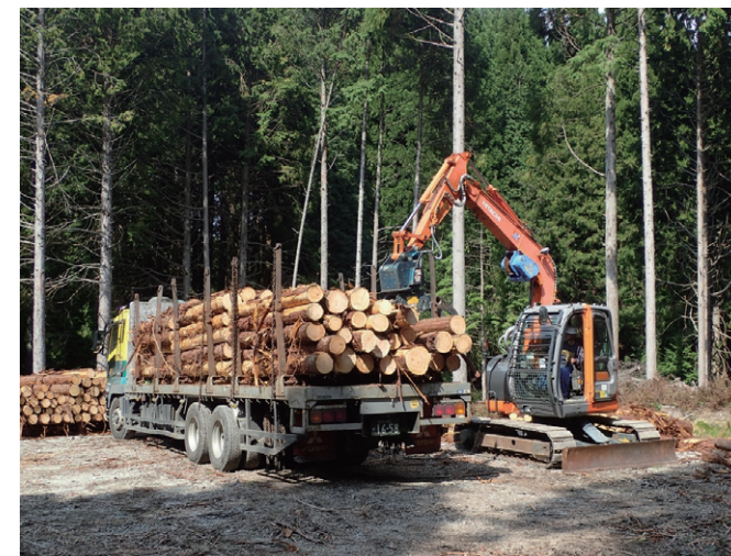
▲大型トラックへの丸太積み込み作業
