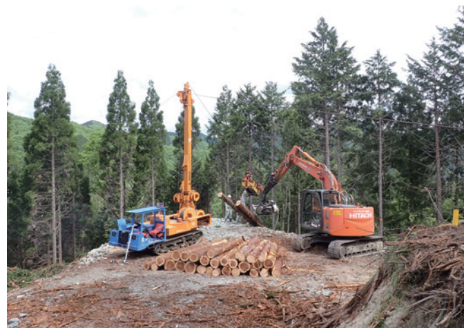
▲高性能林業機械による間伐材の集積状況
